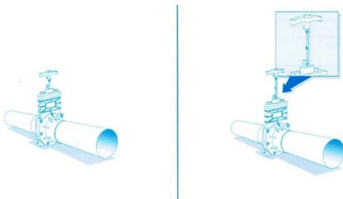
Las dimensiones de la llave son las mismas para DN100 y DN110. Para obtener una llave DN100, hay que colocar cada reductor a un lado y otro de la llave
